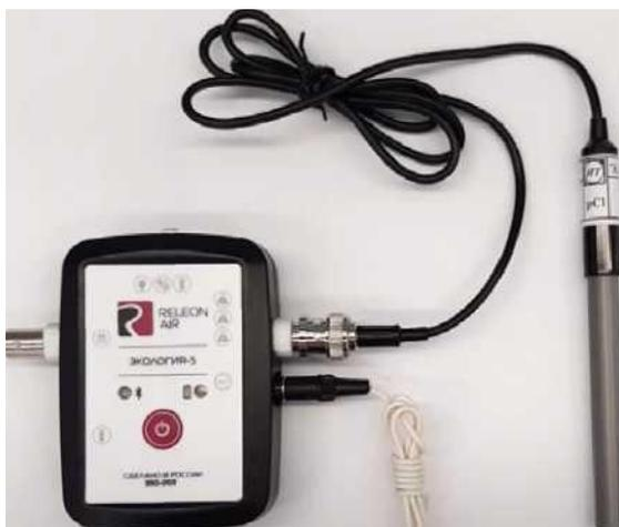
Рис. 10. Ионоселективный датчик (присоединены электро хлорид-ионов и электрод сравнения)
