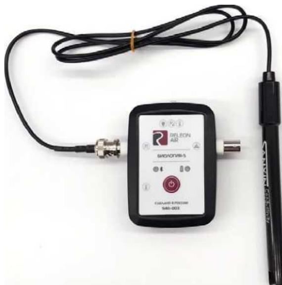
Рис. 5. Датчики электропроводимости
