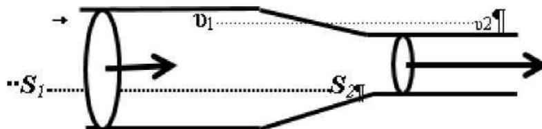
$$v_1 = v_2; \dots v_1 = v_1 \frac{S_2}{S_1}; \dots v_2 = \dots v_1 \frac{S_1}{S_2}; \dots v_2 = v_1 \frac{S_1}{S_2}$$
