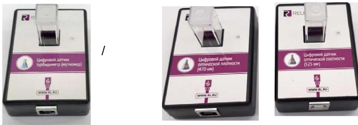
Рис. 8. Датчики мутности (слева), оптической плотности на 465 нм (в центре) и 525 нм (справа)
