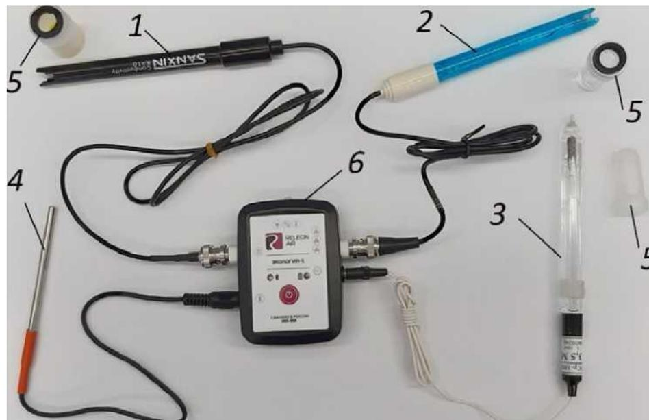
*Рис. 9.* Снаряженный мультидатчик по экологии. Обозначения: 1 – щуп датчика электропроводимости, 2 – щуп датчика pH, 3 – электрод сравнения, 4 – щуп датчика температуры, 5 – защитные колпачки (сняты)
