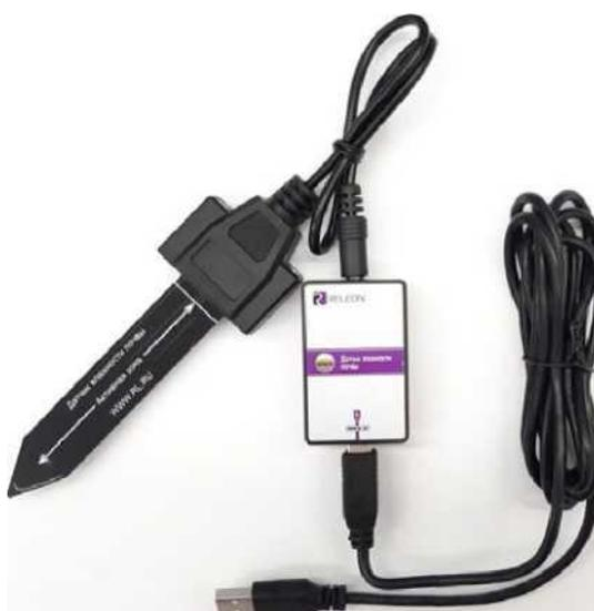
Рис. 4. Датчик влажности почвы
