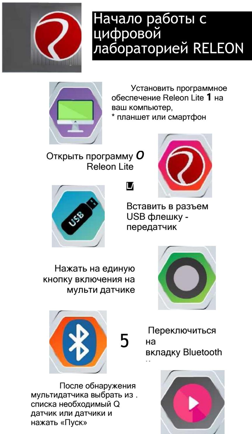
Рис. 14. Алгоритм работы с программным обеспечением *Releon Lite*
